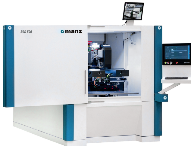
Bild 1. Battery-Laser-System: flexible, modulare Plattform für unterschiedliche Laserprozesse
